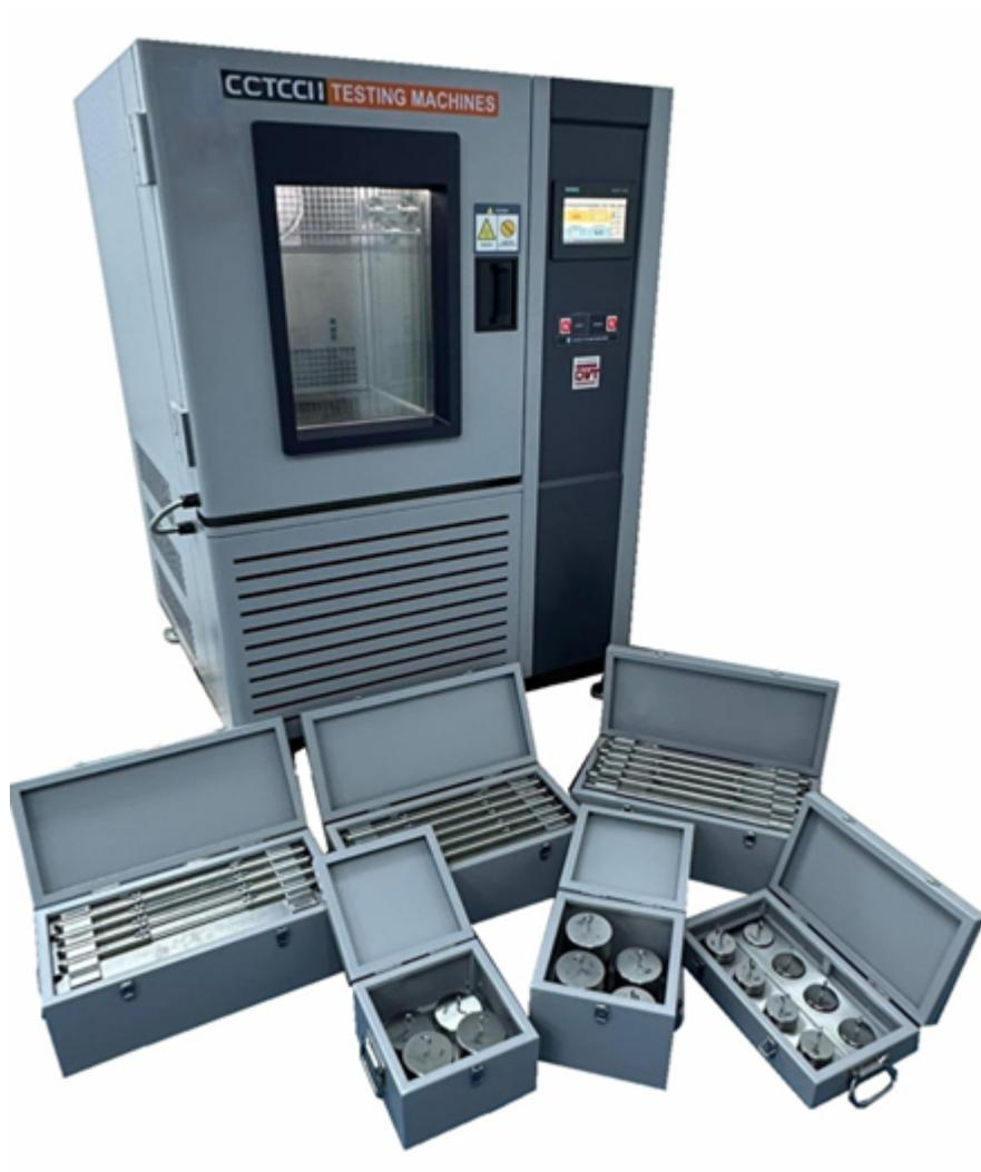
PERMET DE MESURER LA RESISTANCE AU FROID DES CABLES ISOLES SOUS GAINÉ
